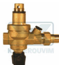
ΑΥΤΟΜΑΤΟΣ ΠΛΗΡΩΣΗΣ ΟΡΕΙΧΑΛΚΙΝΟΣ ΧΩΡΙΣ ΜΑΝΟΜΕΤΡΟ, ΒΑΡΕΩΣ ΤΥΠΟΥ PN16 - 1/2" +80°C
