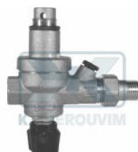
ΑΥΤΟΜΑΤΟΣ ΠΛΗΡΩΣΗΣ ΧΡΩΜΕ ΧΩΡΙΣ ΜΑΝΟΜΕΤΡΟ, ΒΑΡΕΩΣ ΤΥΠΟΥ PN16 - 1/2" +80°C
