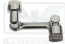
ΦΙΛΤΡΑΚΙ ΠΟΛΛΑΠΛΩΝ ΑΡΘΡΩΣΕΩΝ M22 X 1 ΘΗΛ. - M24 X 1 ΑΡΣ. ΧΡΩΜΕ ΓΙΑ ΡΟΥΞΟΥΝΙΑ ΜΠΑΤΑΡΙΩΝ
